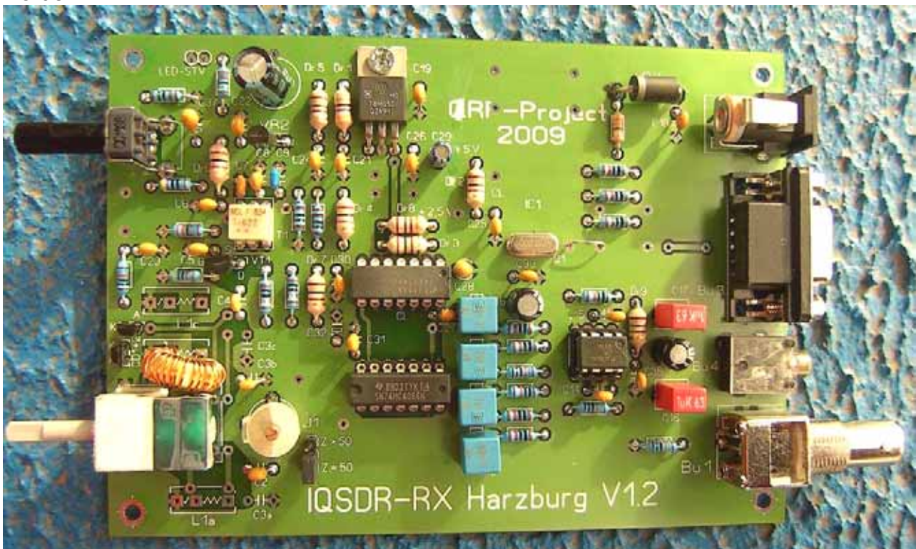
Bild der bestückten Platine des SDR Receiver „Harzburg“.
